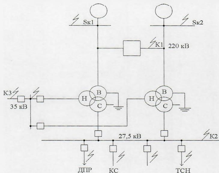
2. Тартылым қосалқы стансасының 27,5 кВ ТҚ К-2 нүктесі үшін қысқа тұйықталу токтарын анықтау. Қ.т. нүктелері мен сұлба элементтерінің берілгендері суретте көрсетілген. Трансформатордың типі ТДТНЭ -40000кВА,  $X_{K1} = 0,485$
